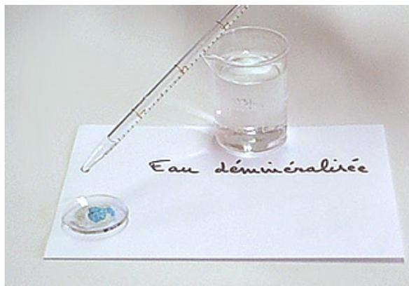
**test du sulfate de cuivre anhydre** Image trouvée sur :
