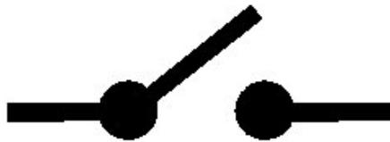
**Interrupteur ouvert** Symbole normalisé de l'interrupteur ouvert.
