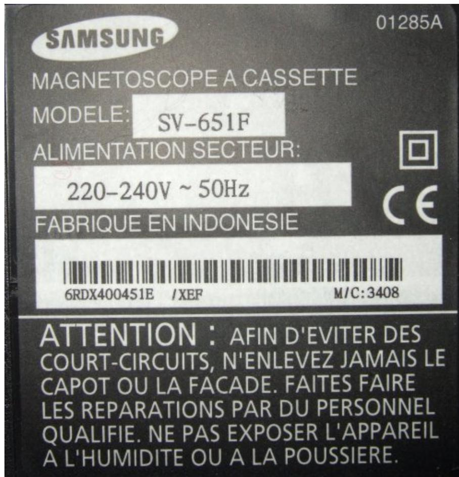
**Tension efficace et fréquence** Tension efficace et fréquence indiquées à l'arrière d'un appareil électroménager.
