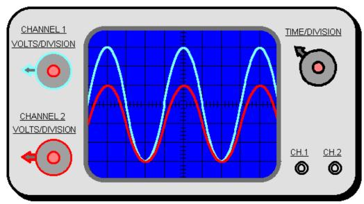
Il faut s'attarder sur l'observatrion de l'axe vertical qui correspond aux valeurs de la tension. Si les valeurs sont différentes sur l'écran de l'oscilloscope alors la tension est dite variable. Dans le cas contraire elle est dite constante.
