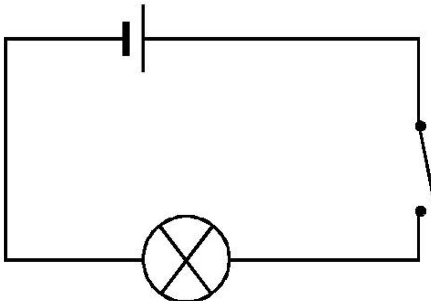
**schéma en série** Schéma d'un montage en série.
