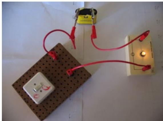
**circuit fermé** Le circuit est fermé et la lampe brille.
