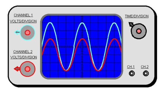
Il faut s'attarder sur l'observatrion de l'axe vertical qui correspond aux valeurs de la tension. Si les valeurs sont différentes sur l'écran de l'oscilloscope alors la tension est dite variable. Dans le cas contraire elle est dite constante.
