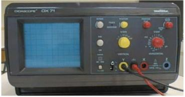
**Oscilloscope** « **didactique** » Notez les différentes couleurs des boutons : GRIS réglage de la trace, JAUNE déviation verticale et ROUGE base de temps.
